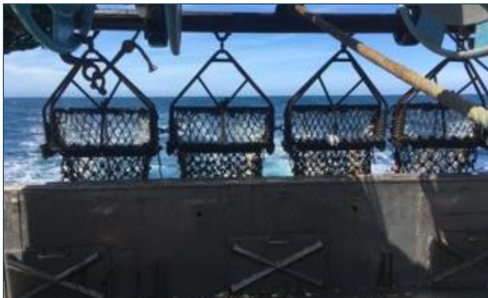
Figure 7 : 4 dragues de 2 maillages différents : à gauche 85mm et à droite 97mm.
